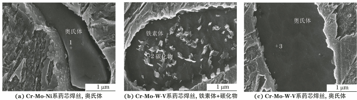
图3 不同药芯焊丝堆焊层的 EDS 分析位置
