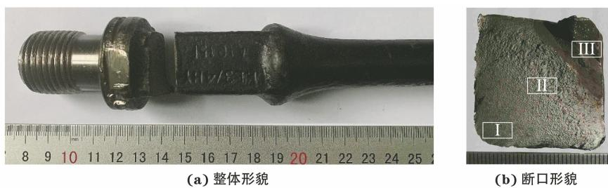
图 1 失效抽油杆整体形貌及断口宏观形貌
