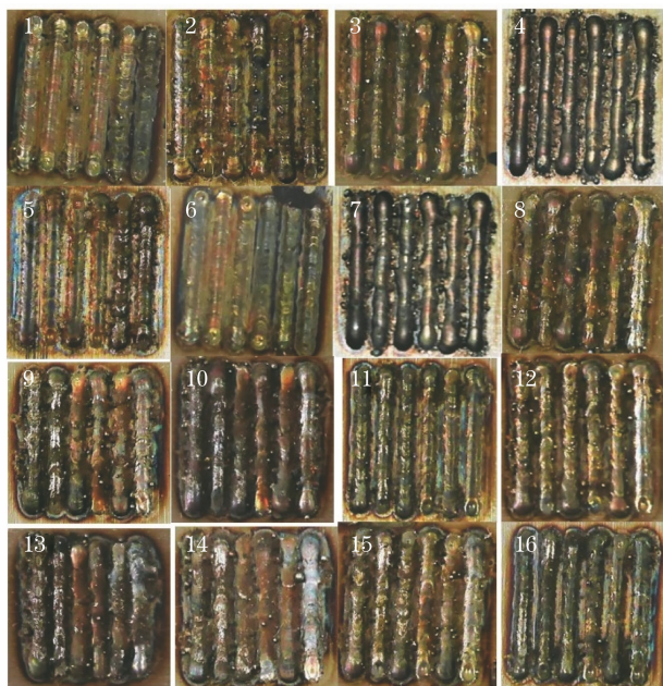
图 4 16 组 316L 不锈钢双极板熔覆试样的表面宏观形貌
