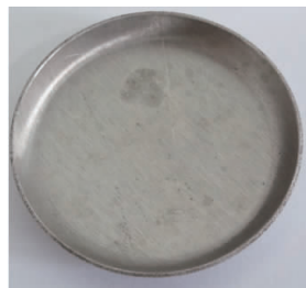
图 4 采用优化成形工艺参数冲压后的成形件
